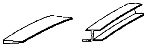
图 15.6-18 型材刀形弯曲
