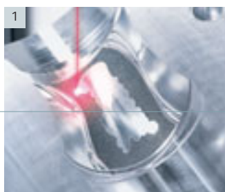
1| PET 注吹模激光表面纹理
