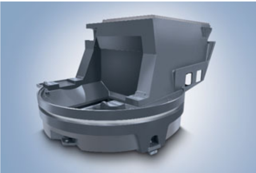
11| DMU 85 monoBLOCK® 经过有限元 FEM 优化的 monoBLOCK® 铸铁机架，重量为 5.1 吨（65 型为 3.7 吨）
