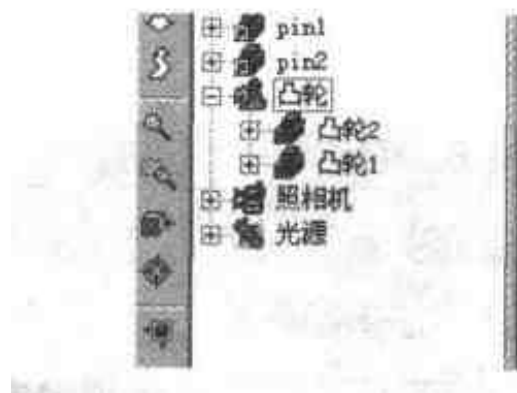
图 5.50 将凸轮 1、2 合并成装配件
