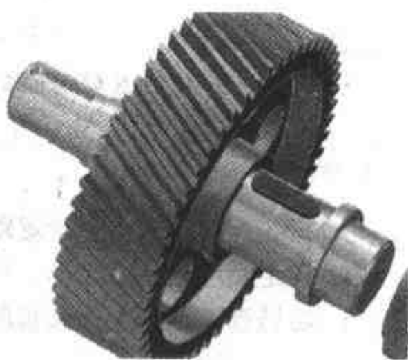
图 3.110 齿轮和轴的约束装配
