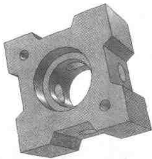
图 3.71 生成对角线圆孔
