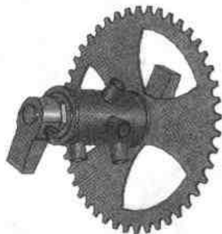
图 3.35 完成最后的销钉零件的装配
