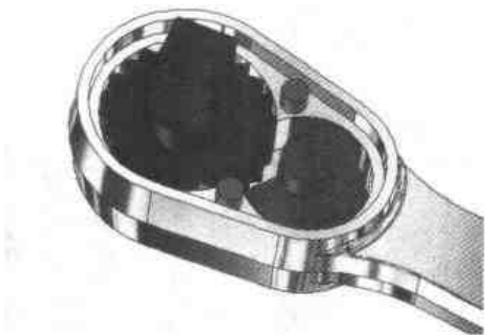
图 5.49 棘轮增加了顺、逆方向的转动
