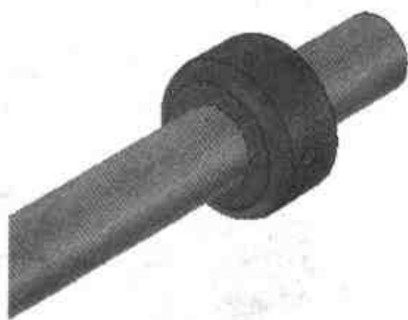
图 3.39 完成止转圈和轴的装配
