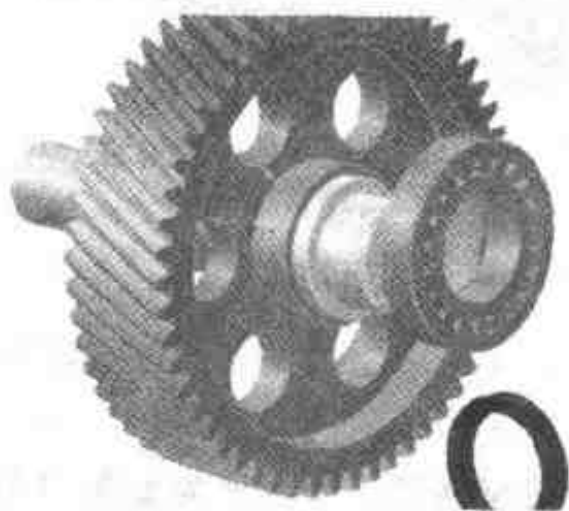
图 3.114 完成齿轮和轴的约束装配
