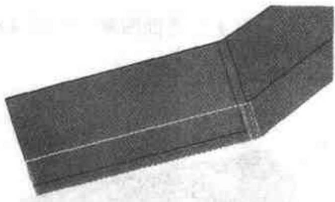
图 4.91 添加【不带料折弯】图素
