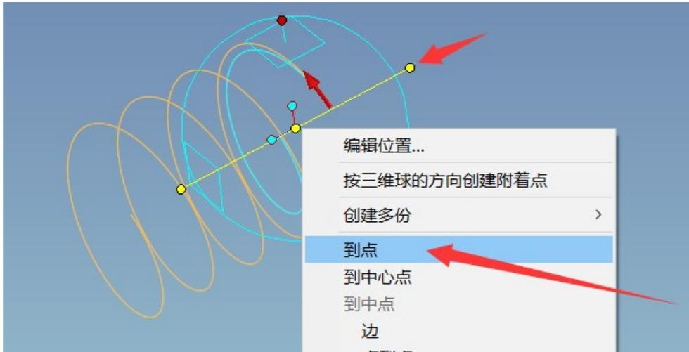
5、同样的方法，插入等节距螺旋曲线，参数如下图：
